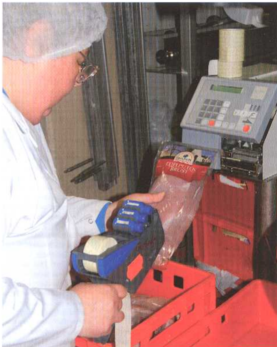
Warenauszeichnung mit MHD-Etikett mit einem Meto-Handauszeichner
